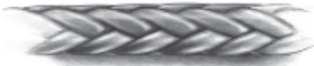
Aspecto de fibras de cable debido a compresión. Se puede ver un cierto brillo. Ésta no es una característica permanente y puede eliminarse flexionando el cable.
