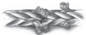
Le câble présente deux torons adjacents coupés – Remplacez le câble.
