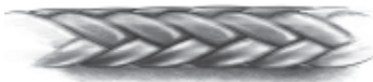
Seil mit Druckschäden an den Strangfasern. Das Seil glänzt etwas. Hierbei handelt es sich nicht um permanente Schäden, die sich durch ein Umlegen des Seils beheben lassen.
