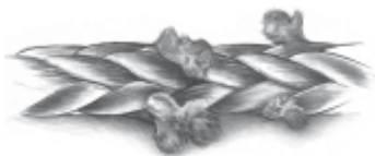
Seil mit zwei durchtrennten Strängen – Seil sollte ausgewechselt werden.
